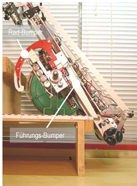
Abb.2d Stützräder halb aufgezogen
